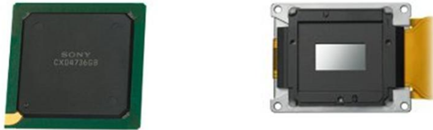
4K Upscaler 畫質提升技術“Reality Creation”（左）及最新研發的 0.74 吋 4K SXR 晶片（右）
